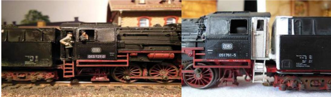
Der restliche Teil des Führerhauses entstand aus der gleichen Pappe und wurde Stück für Stück anfangend mit der Rückwand über Boden und Seitentüren und endend mit den Griffstangen aus Kupferdraht und der Aufstiegsleiter fertiggestellt.
